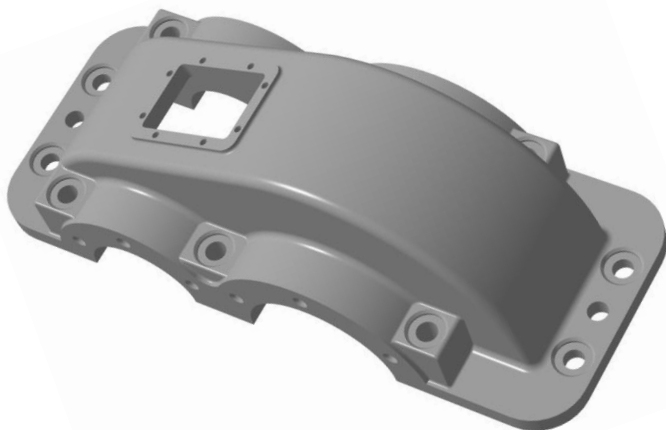
Рис. 3.195. Внешний вид детали (крышки зубчатого редуктора – к чертежу на рис. 194), приведенной как типичный пример, когда целый ряд ее размеров должен выдерживаться при совместной обработке с другой деталью – корпусом редуктора
