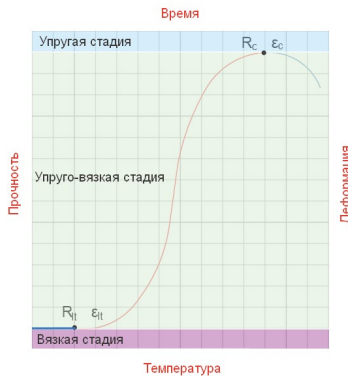
Рис. 3.3. Характеристики асфальтобетона в зависимости от температуры (времени нагружения):
