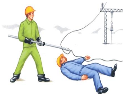
Рис. 9.6. Освобождение пострадавшего от действия электрического тока в электроустановках свыше 1кВ отбрасыванием провода изолирующей штангой
