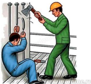
Рис. 9.5. Освобождение пострадавшего от действия электрического тока в электроустановках до 1 кВ перерубанием провода
