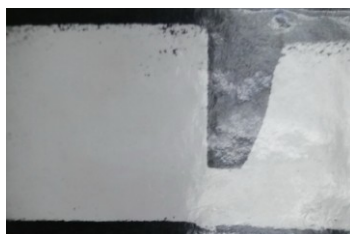
Рисунок 2 - Профиль поверхности, полученный при вдавливании конусного выступа матрицы в листовую заготовку из алюминия А5 толщиной 2 мм
