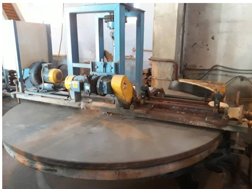
Рисунок 1 – Установка для получения алюминиевых гранул по «сухой»
