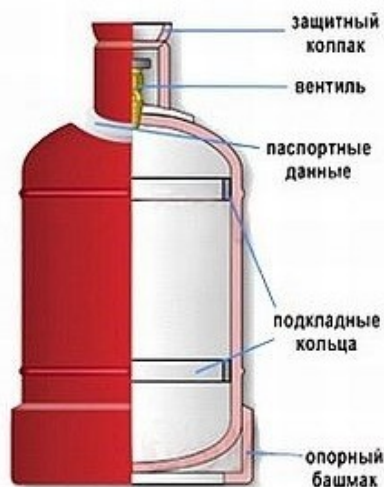
Рисунок 1 - Схема бытового газового баллона с конструктивными элементами
