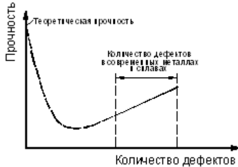
Рисунок 2. Изменение прочности металлов с ростом числа дислокаций
