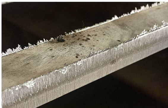
Рис. 1. Поверхность после лазерной резки (алюминий)
