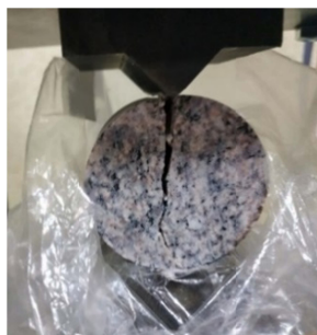
Рис. 1. Оснастка испытательной машины Zwick, разработанная для изучения влияния радиуса притупления зубьев дробящей плиты на усилие разрушения фрагмента
