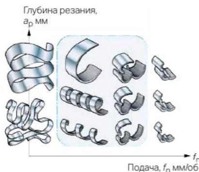
Рис. 1 – Диаграмма «глубина резания – подача»
