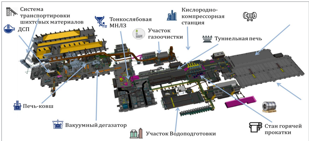
Рис. 3. Основные технологические участки и агрегаты «Литейно-прокатного комплекса»
