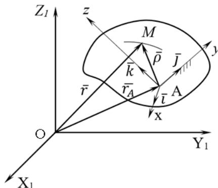
Рис. 1. Схема сложного движения точки:  $\bar{r} = \bar{r}(t)$  – абсолютное движение точки М относительно неподвижной системы координат  $X_1, Y_1, Z_1$ ;  $\bar{\rho} = \bar{\rho}(t)$  – относительное движение точки М относительно подвижной системы координат  $x, y, z$ , жестко связанной с движущимся телом;  $\bar{r}_A = \bar{r}_A(t)$  – переносное движение той точки тела, совпадающей в данное мгновение с движущейся точкой М, относительно неподвижной системы координат  $X_1, Y_1, Z_1$ .
