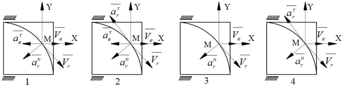
Рис. 2. Схемы сложного движения точки
