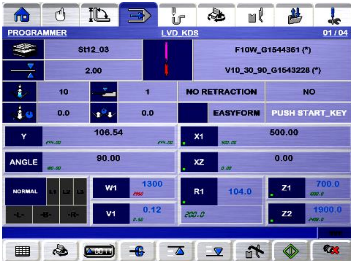
Рис. 13. Общий вид программы прессы при гибке лонжерона из различных металлов
