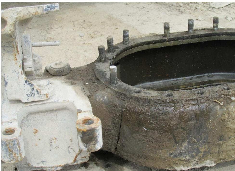
Рис. 5. Характерное эксплуатационное разрушение литого картера ведущего моста
