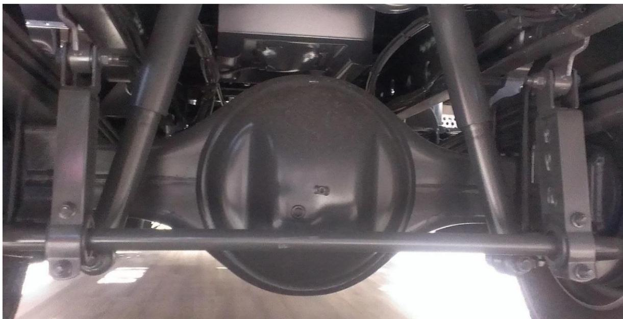
Рис. 2. Ведущий мост со штампованным картером
