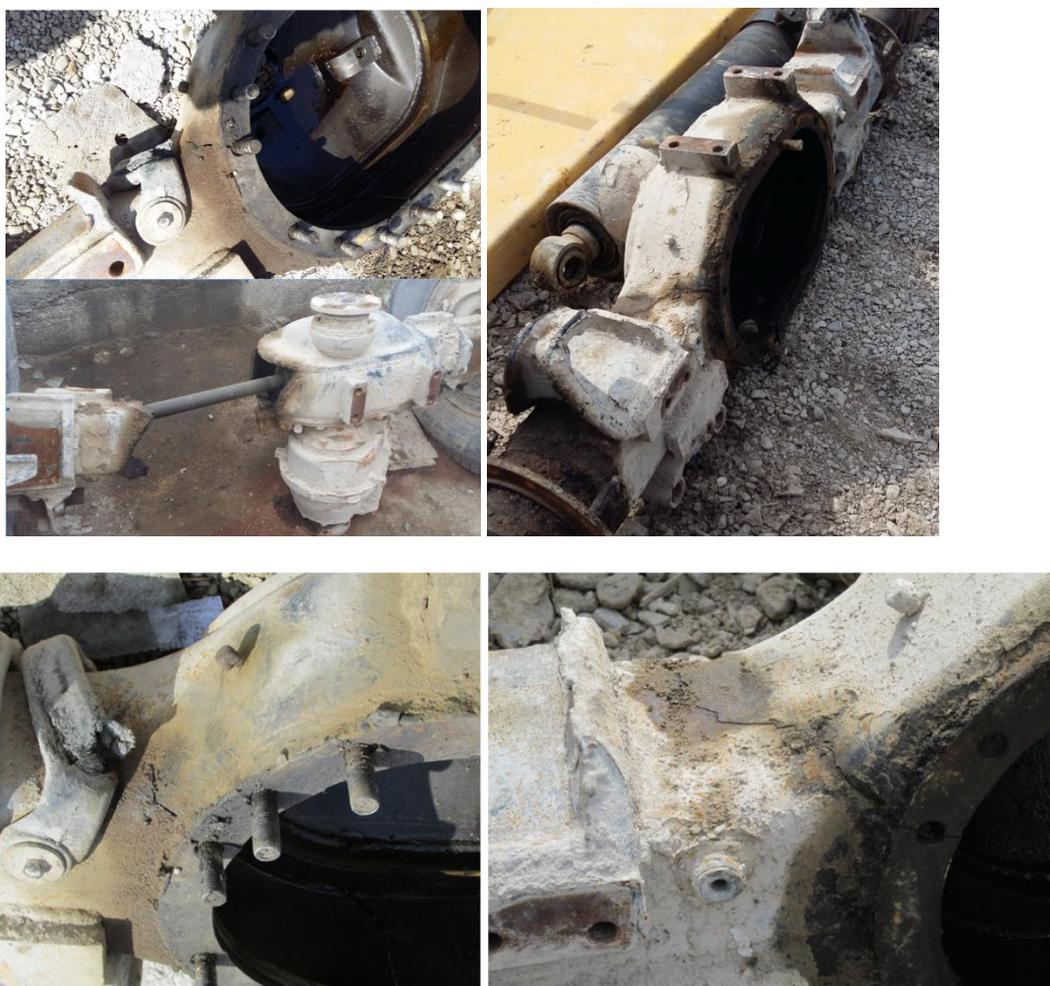
Рис. 4. Локализация эксплуатационных разрушений картеров ведущих мостов
