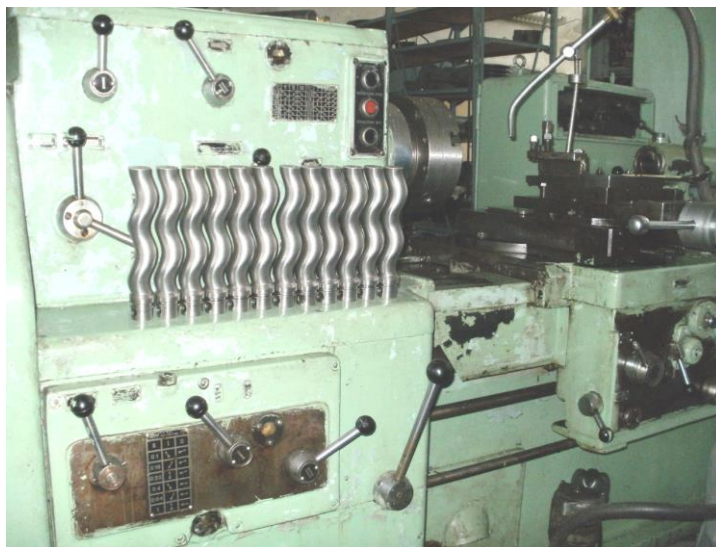
Рис. 5. Фото модернизированного токарно-затыловочного станка модели 1B811 с партией обработанных на нем винтовых роторов
