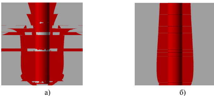
Рисунок 7 – Оценка предельного состояния породного массива в окрестности шахтного ствола
