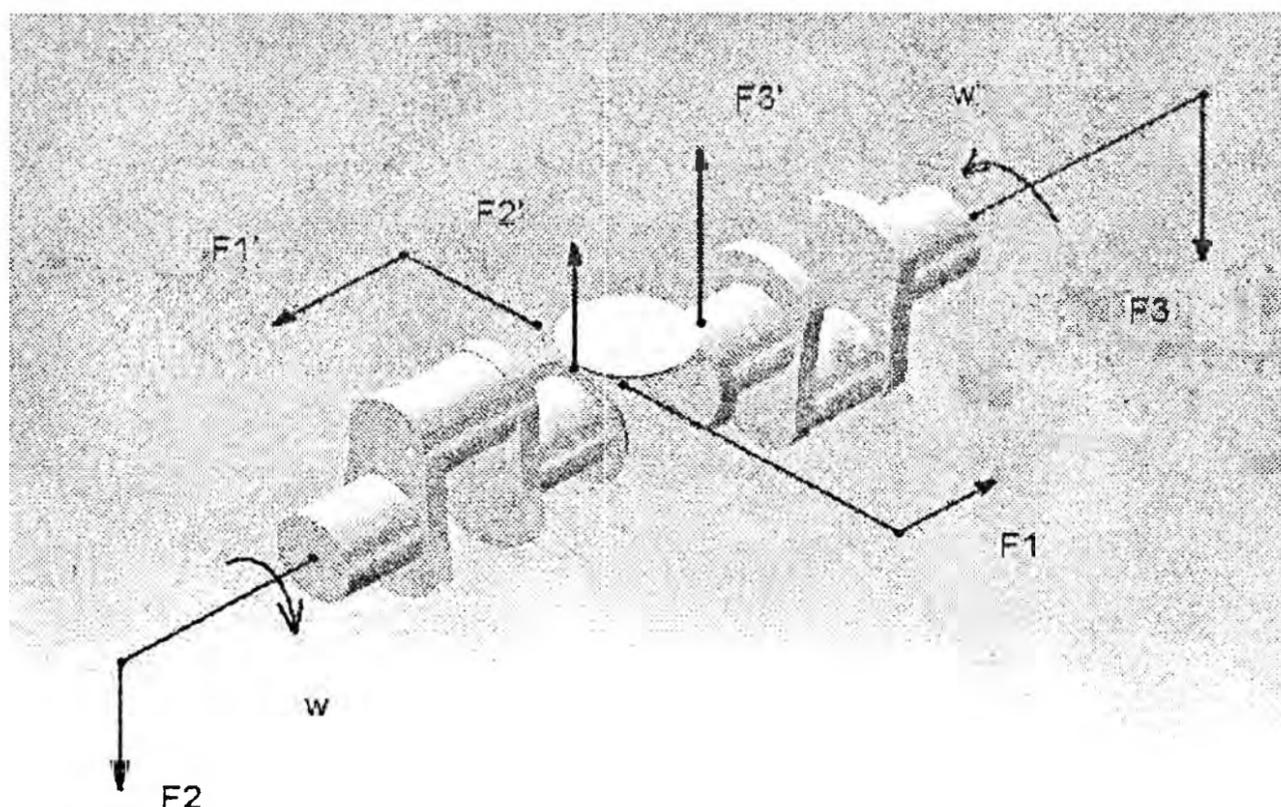
Рисунок 2 – Схема уравнивания гироскопических сил
