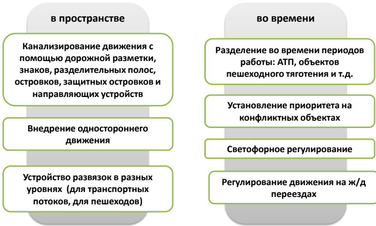
Рис. 3.5. Схема методов, входящих в группу «Разделение потоков»
