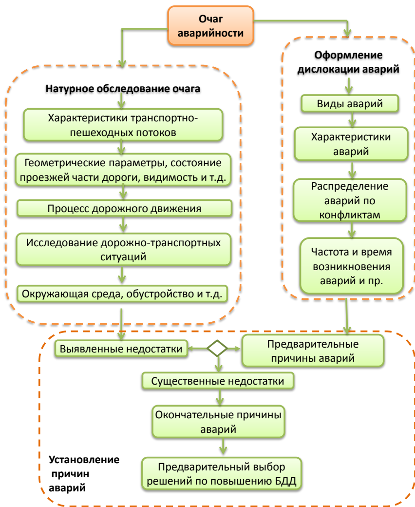
Рис. 4.1. Процесс исследования очагов аварийности
