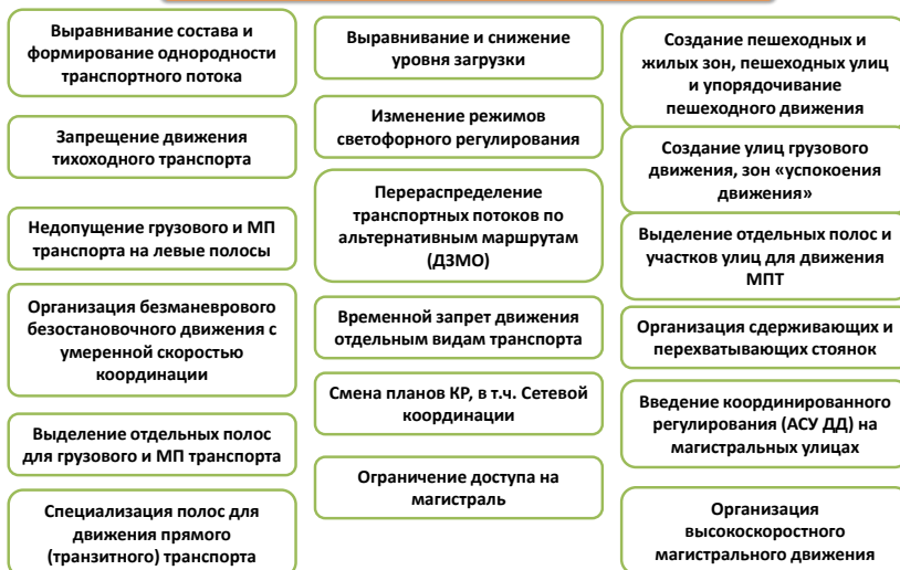
Рис. 3.8. Схема методов, входящих в группу «Специализация улиц и дорог»
