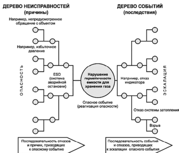
Рис. 2. Схематическое представление опасного события (аварийной ситуации) и связанных с ним событий с помощью дерева отказов и дерева событий
