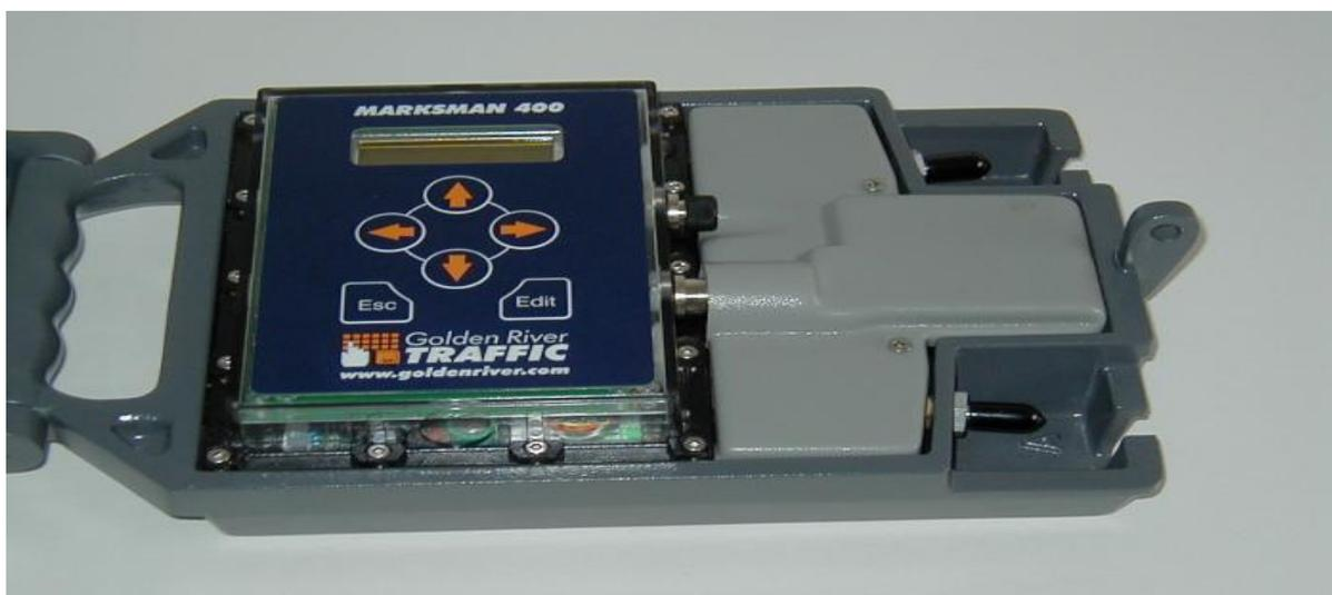
*Рисунок 1 - Микропроцессорный блок счетчика-классификатора транспортных средств*
