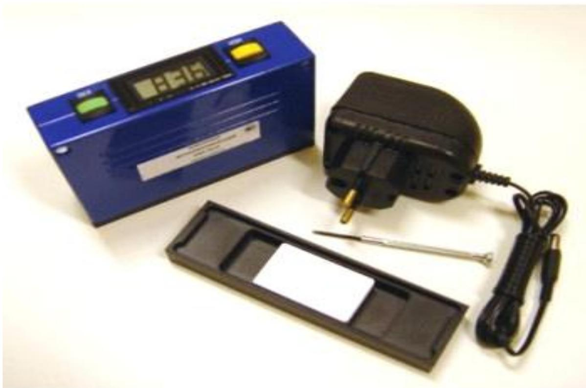
*Рисунок 1- Общий вид блескомера БФ5*
