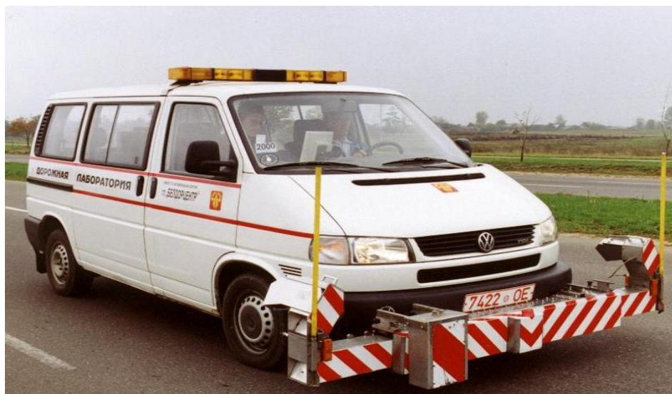
*Рисунок 1 — Измерительная установка "Профилограф"*
