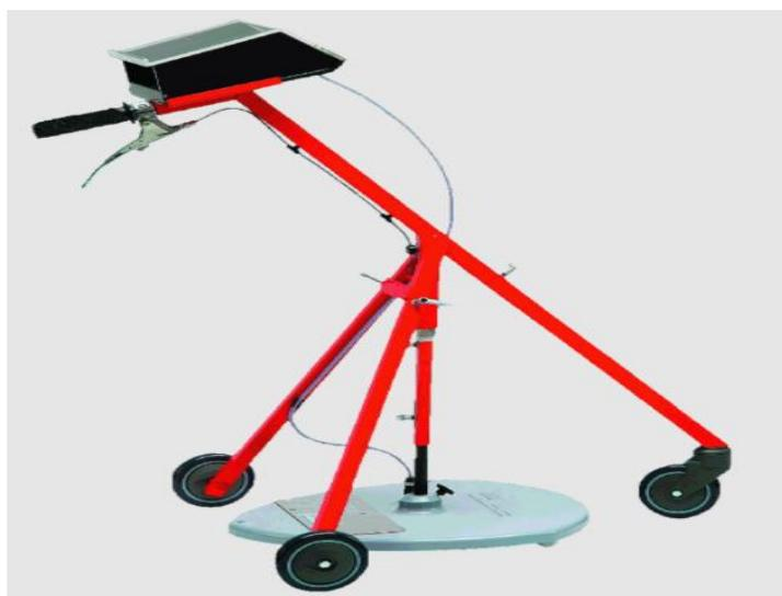
Рисунок 9.10 Толщиномер дорожного покрытия StratoTest 4100.
