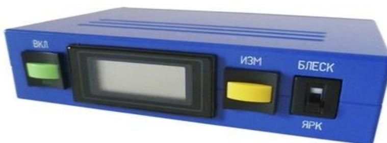
*Рисунок 2- Кнопки управления блескомера БФ5*
