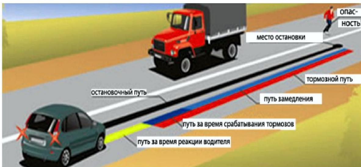
Рисунок 1– Определение тормозного пути автомобиля
