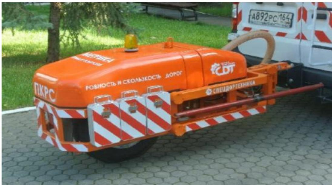
Рисунок 1 - Установка для измерения коэффициента продольного сцепления ПКРС-3.
