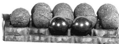
Рис. 1.28. Формирование внешней оболочки шарового ТВЭЛа
