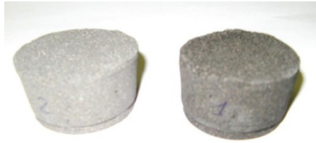
Рисунок 1 – Внешний вид брикетов, формирование которых осуществляли вручную с помощью трамбовки в пластиковых формах
