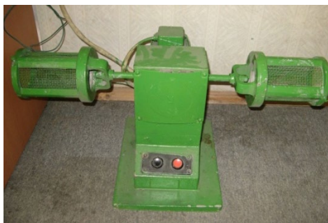
Рисунок 4 – Прибор для определения осыпаемости песчаных стержней
