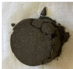
Рисунок 2 – Брикет после испытаний его на раздавливание
