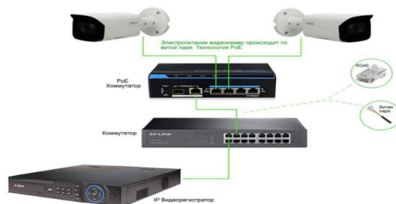
Рис. 1. Схема подключения IP-видеокамер по технологии PoE
