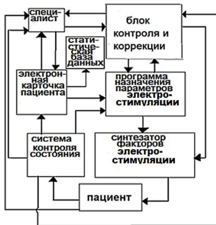
Рис. 1. Схема дистанционной системы электростимуляции при наличии ночного апноэ
