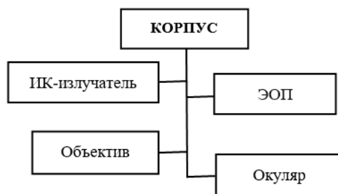
Рис. 1. Укрупненная схема сборки монокуляра
