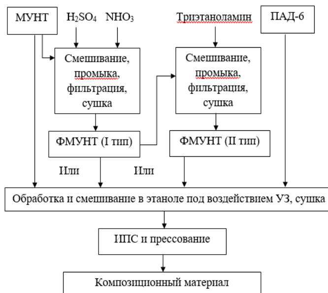
Рис. 1. Технологическая схема получения композиционного материала с МУНТ
