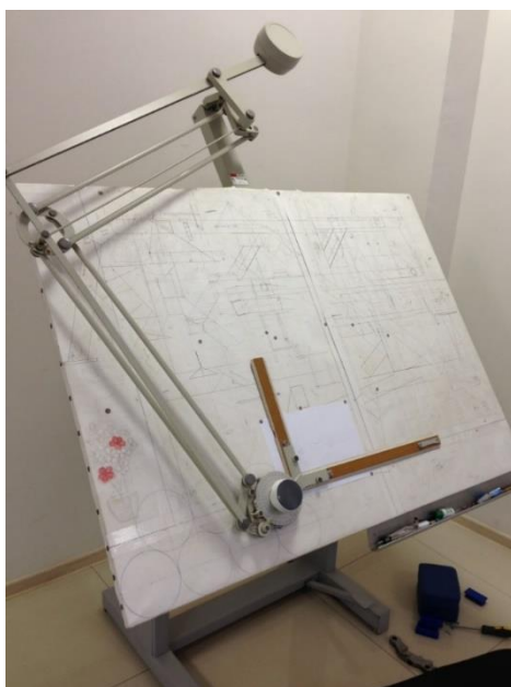
Рисунок 1 – Кульман – прибор, используемый до появления САПР для выполнения строительных чертежей
