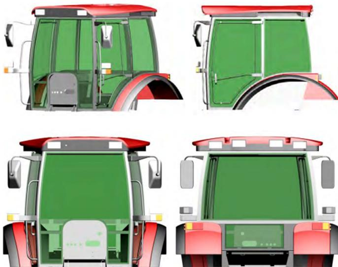
Рис. 6.1. Кабина для тракторов «Беларус» мощностью 90–350 л. с.
