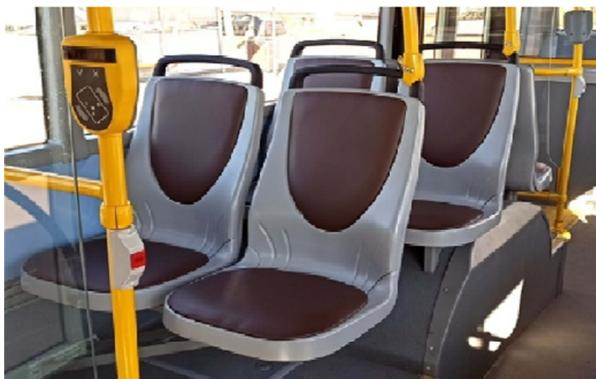
Рис. 6.3. Вариант дизайн-решения установки сидений над колесной аркой троллейбуса
