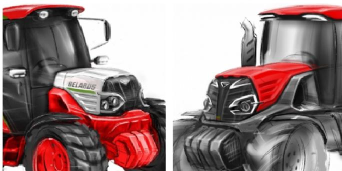
Рис. 6.2. Варианты эскизной проработки облицовки моторного отсека и светотехники колесного трактора МТЗ
