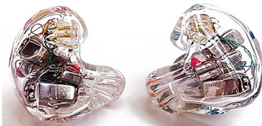
Рис. 3.3. Стереотелефоны Custom с 8-ю излучателями [29]
