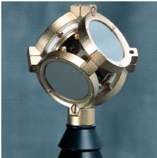
Рис. 1.35. Внешний вид четырех кардиоидных микрофонов системы Soundfield, размещенных в форме тетраэдра
