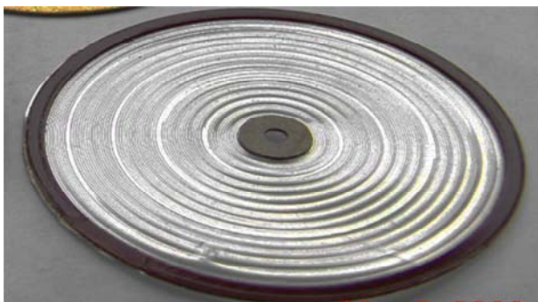
Рис. 2.10. Внешний вид гофрированной майларовой мембраны в ортодинамическом громкоговорителе [17]
