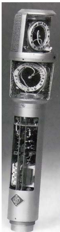
Рис. 1.29. Совмещенные микрофоны в системе XY [6]
