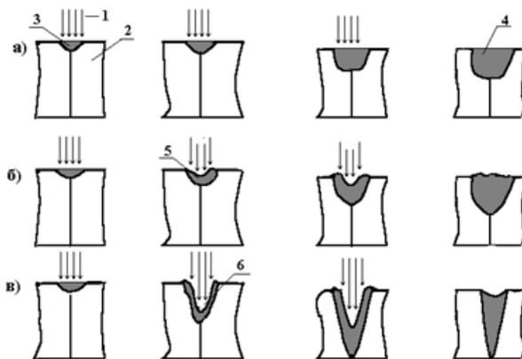
Рис. 1. Стадии проплавки соединяемых деталей: 1 – лазерное излучение; 2 – детали; 3 – расплав; 4 – сварочная ванна; 5 – заглубление; 6 – отверстие, образованное вследствие перехода расплава в газообразную фазу; а –  $10^5-10^6$  Вт/см<sup>2</sup>, б –  $5 \cdot 10^5-5 \cdot 10^6$  Вт/см<sup>2</sup>, в –  $10^6-10^7$  Вт/см<sup>2</sup>
