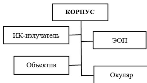
Рис. 1. Укрупненная схема сборки монокуляра
