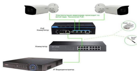
Рис. 1. Схема подключения IP-видеокамер по технологии PoE
