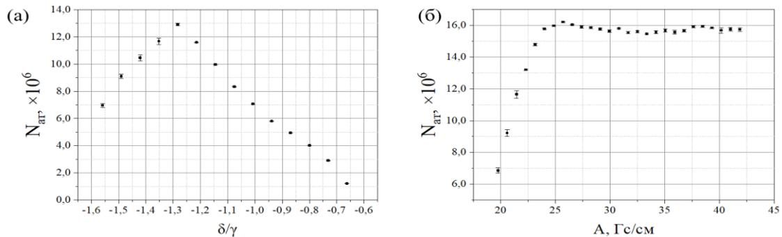
Рис. 1. Зависимость количества атомов  $^{174}\text{Yb}$ , захваченных в МОЛ, от частотной отстройки излучения МОЛ от резонанса охлаждающего перехода  $\delta$  по отношению к ширине линии этого перехода  $\gamma$  (а), и от градиента магнитного поля  $A$  (б)
