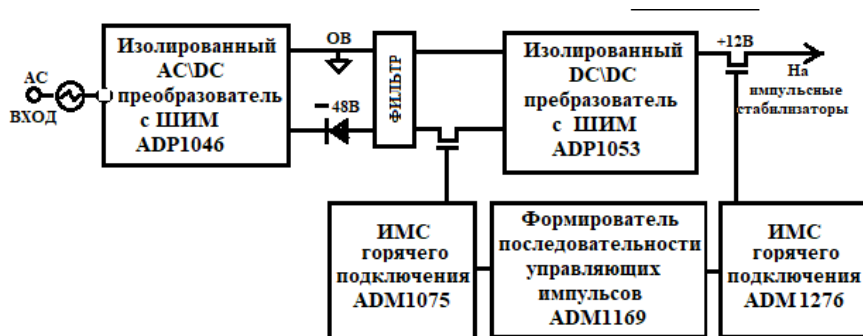
Рис. 1. Обобщенная структурная схема преобразователя сетевого электропитания быстродействующего электронного устройства
