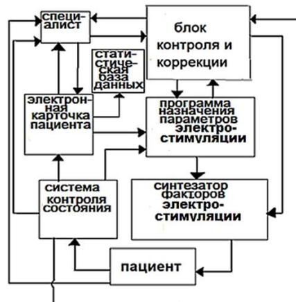
Рис. 1. Схема дистанционной системы электростимуляции при наличии ночного апноэ
