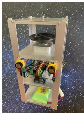
Рис. 2. Габаритный макет МКА
