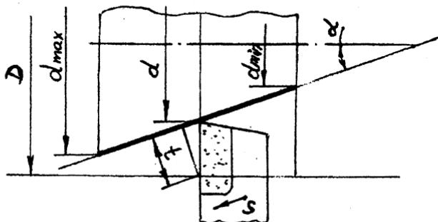
Рис. 1. Точение конической поверхности с переменной глубиной резания.
