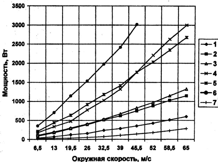
Рис. 1. Зависимость мощности обработки от окружной скорости вращения образца: 1 -  $V=0,3$  Тл, вращение без порошка; 2 -  $V=0,3$  Тл, МАО; 3 -  $V=0,5$  Тл, вращение без порошка; 4 -  $V=0,5$  Тл, МАО; 5 -  $V=0,8$  Тл, вращение без порошка; 6 -  $V=0,8$  Тл, МАО; 7 - мощность холостого хода
