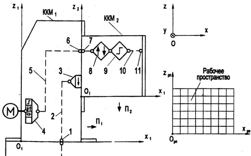
Рис.1. Структурная компоновочно-кинематическая схема станка
