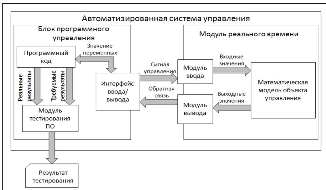
Рисунок 1 – Схема реализации тестирования кода программно-аппаратного комплекса ЧПУ
