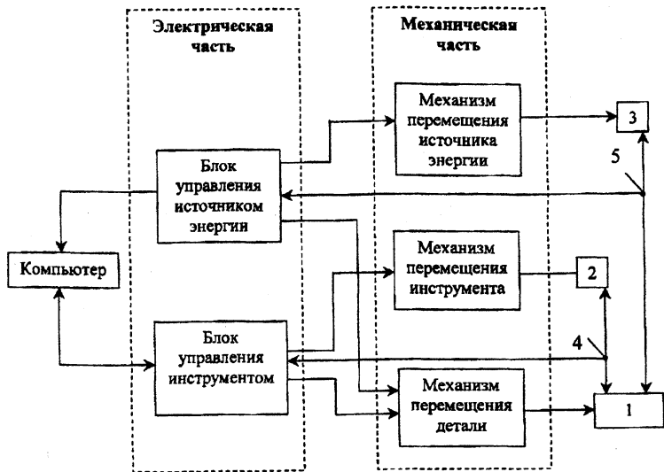
Рис. 3. Структурная схема мехатронной производственной системы: 1 – обрабатываемая деталь, 2 – инструмент, 3 – концентрированный источник энергии, 4 – датчик перемещений, 5 – датчик интенсивности потока энергии
