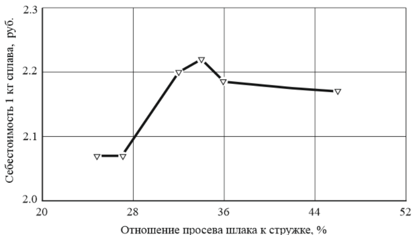
Рис. 2.13. Влияние отношения просева шлама к стружке на себестоимость получаемого сплава
