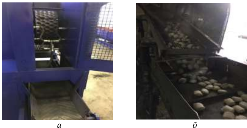
Рис. 3.14. Валковый пресс для получения брикетов разжижителя на основе ОПВА: а – валковый пресс; б – брикеты на основе ОПВА
