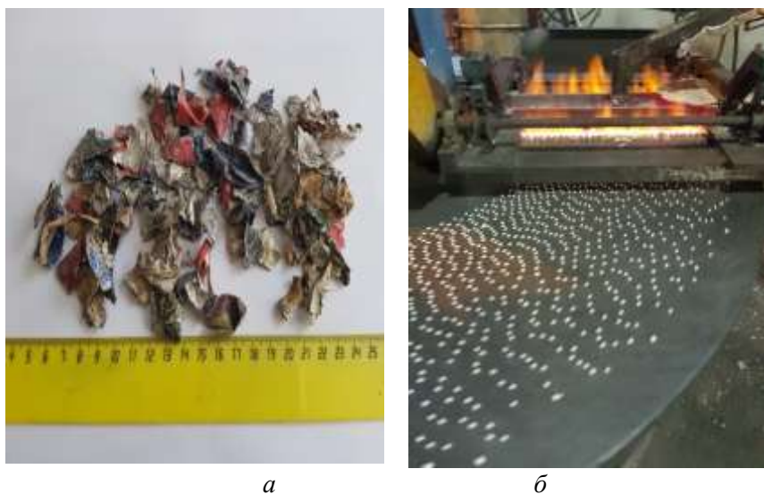
Рис. 3.18. Отходы алюминия 4 сорта класса Г ( a ) и завершающая стадия получения «сухих» гранул ( б )
