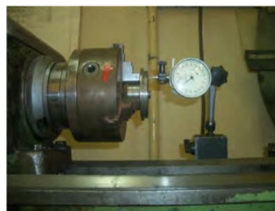
Рис. 4. Установка для оценки абразивной способности и износостойкости алмазосодержащего покрытия на боковых поверхностях распиловочных дисков: а – принципиальная схема; б – общий вид экспериментальной установки; 1 – распиловочный диск; 2 – центральный болт; 3 – планшайба; 4 – истираемый образец; 5 – измерительный шток индикатора; 6 – индикатор МИГ-1
