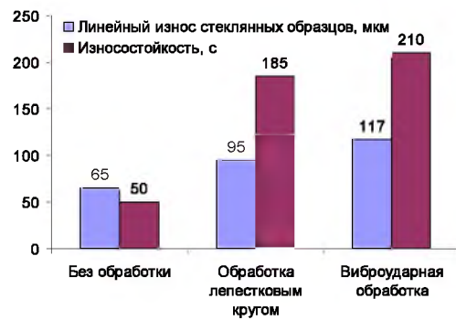
Рис. 5. Значения линейного износа стеклянных образцов и износостойкости алмазосодержащего покрытия, полученного на поверхности испытуемых распиловочных дисков
