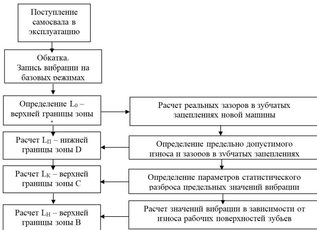
Рисунок 3 – Алгоритм расчетных зон уровней вибраций для автоматизированной оценки технического состояния зубчатых пар редуктора мотор-колеса
