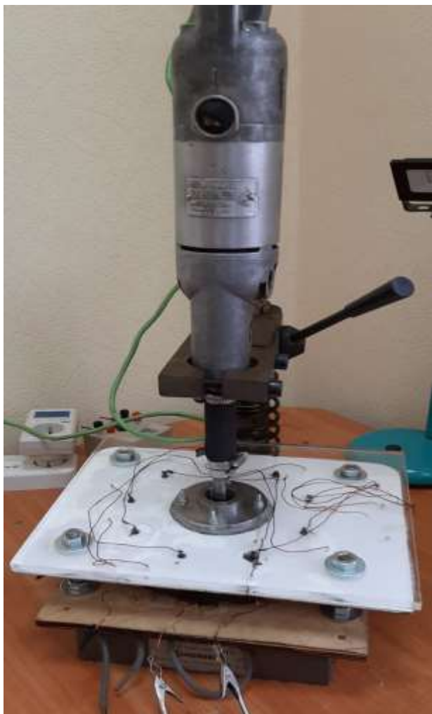
Рис. 2 – Общий вид стенда для испытаний аксиальных ветрогенераторов малой мощности
