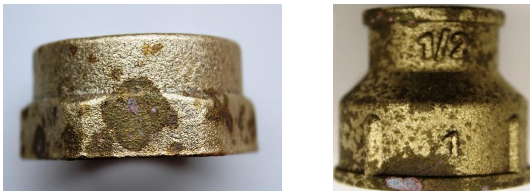
Рисунок 1 – Внешний вид поверхности отливок из сплава марки ЛЦ40С д пораженной пятнами
