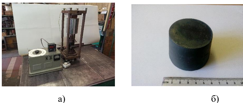
Рисунок 3 – Лабораторная установка горячего статического прессования (а) и образец заготовки катода из комплексного силицида (б)
