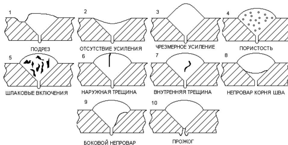
Рисунок 2 – Дефекты сварных швов
