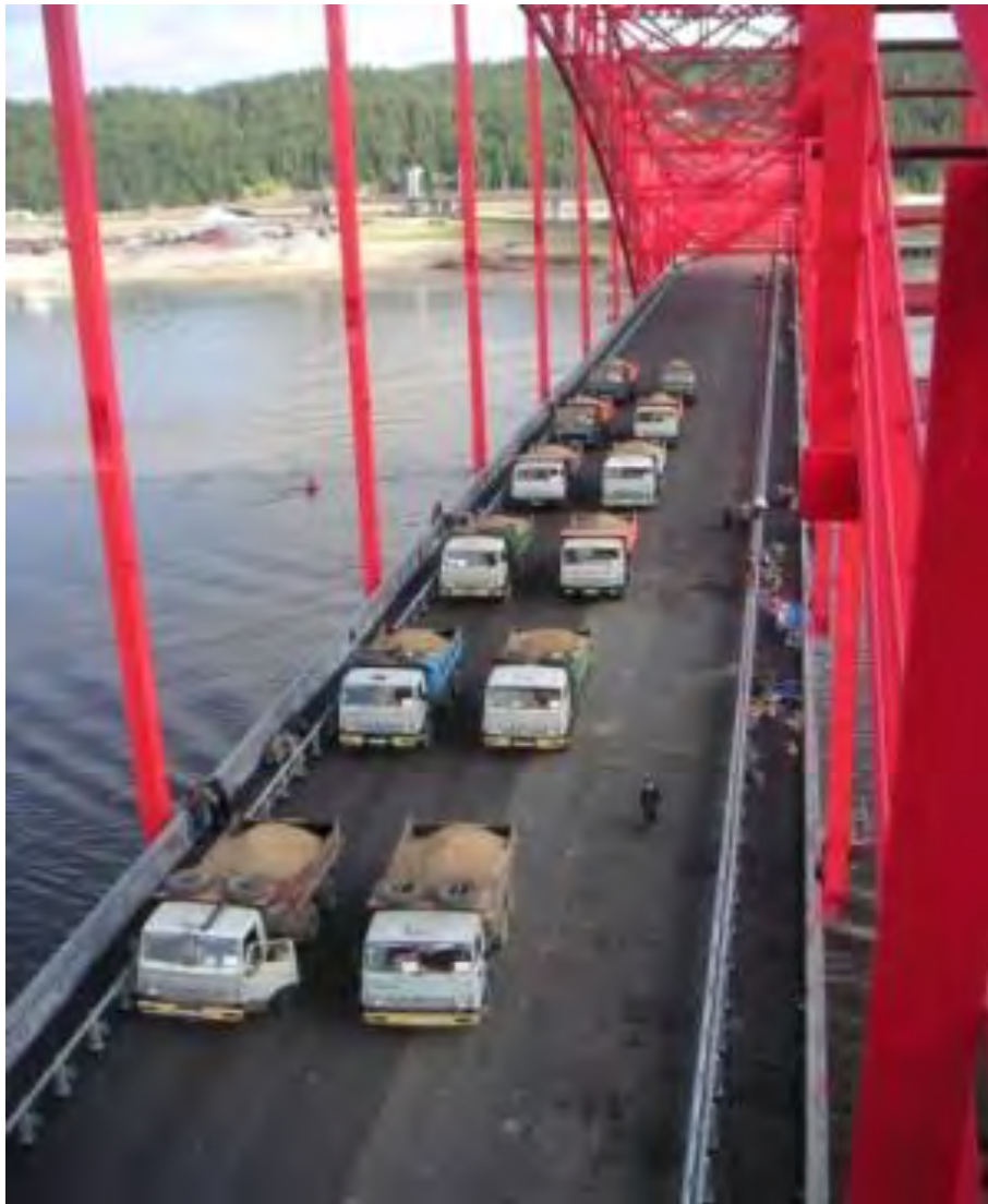
Рисунок 3 – Статические испытания моста
