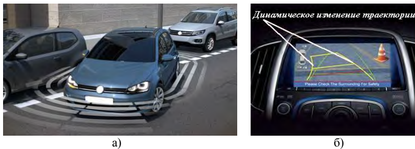
Рисунок 1 – Система паркования автомобиля: а) выбор места для паркования; б) – дисплей работы алгоритма паркования
