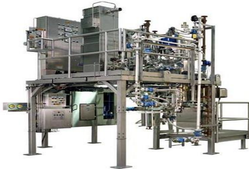
Рисунок 2 Испаритель для промышленной очистки воды
