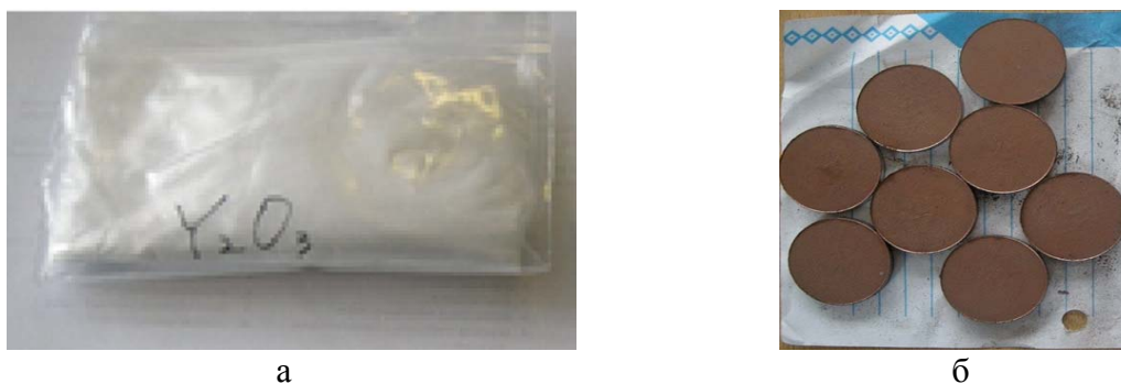
Рисунок 1 – Общий вид ультрадисперсного порошка: а – оксида иттрия; б – лигатуры на основе меди
