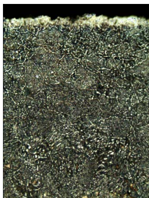
Рисунок 1 – Микроструктура цементованного слоя (точка № 15) x500
