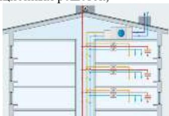
Рисунок 1. Централизованная зональная схема вентиляции в здании
