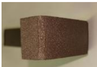
Рисунок 6 – Пластина с загибом радиусом 10 мм напыленная порошком из хромокремниевого чугуна 80-150 мкм. (трещины)
