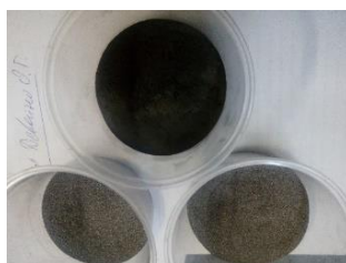
Рисунок 4- Образцы различных фракций порошков из хромокремниевое чугуна
